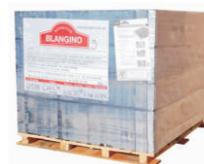
Los pallets llevan la identificación correspondiente: nombre del cliente, material y código correspondiente, fecha y peso aproximado en Kg. Todo sujeto y sellado con film plástico para mantener uniforme la pérdida de humedad de las placas dentro del pallet, minimizando las posibles diferencias de tonalidades por cambio de humedad, las cuales se normalizan con el tiempo.
